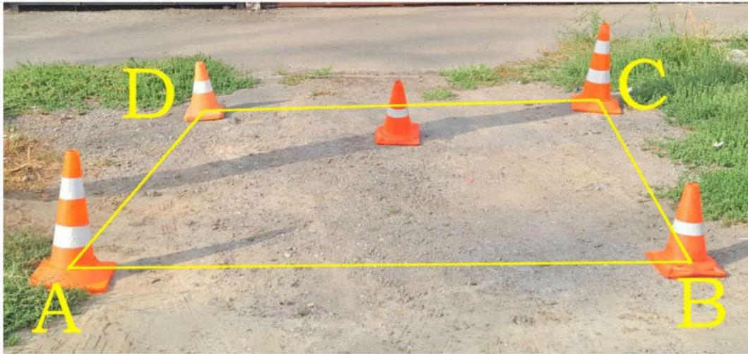
Рис. 5. Изображение разметки в виде квадрата ABCD со стороной 2 метра
